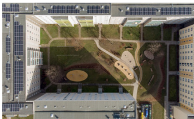
Photovoltaikanlagen auf Flachdächern in Dölitz (li.) und Paunsdorf: In diesen Stadtteilen werden im Herbst 2021 neue Module für Anlagen mit einer Gesamtleistung von 500 kWp installiert.
